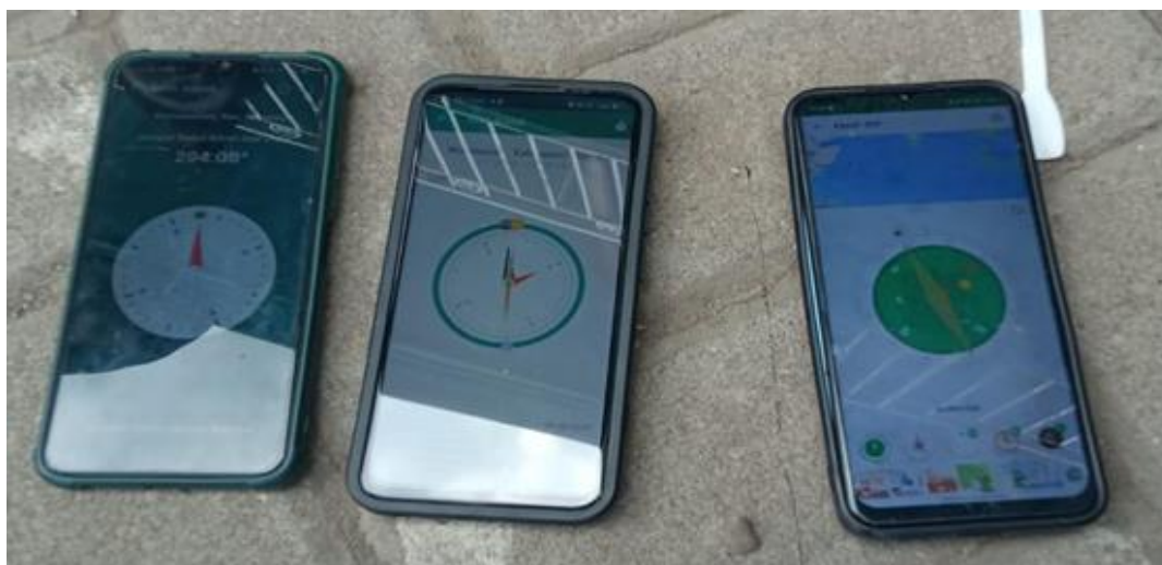
Gambar 5 Cek Kalibrasi dengan Handphone
