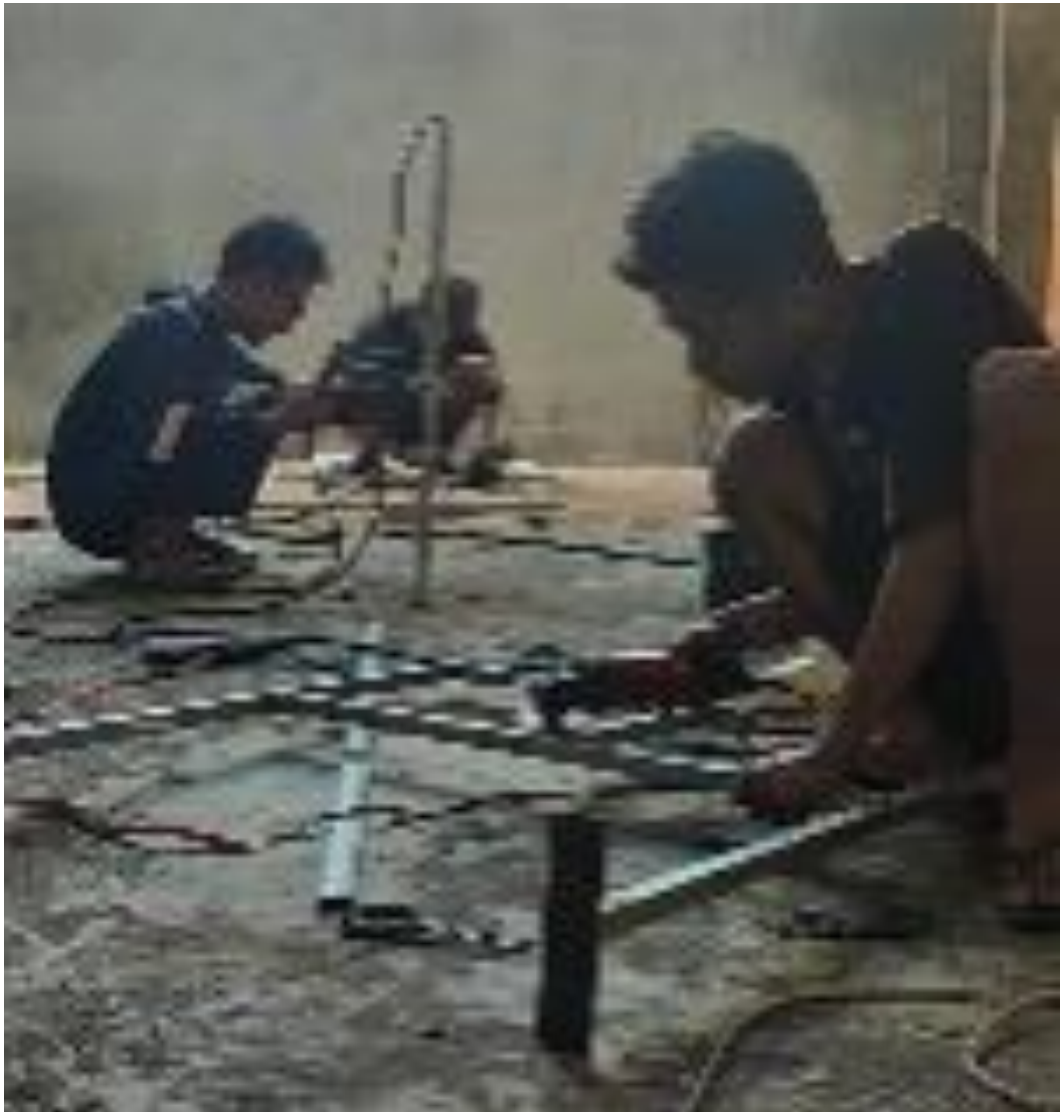
Gambar 5 Proses pengelasan rangka tempat sampah
